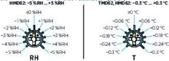
图 2. RH 和 T 微调电容调整范围 (图示)
